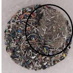
Figura 14. Fracción media donde se aprecia el aglomerado de fibra
