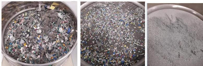
Figura 11. Imagen de distintos tamices tras el cribado
