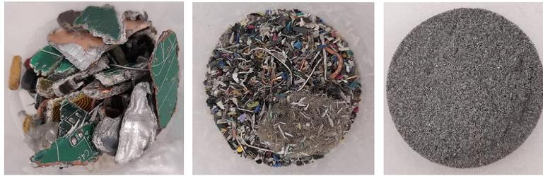
Figura 12. Muestras recogidas de la fracción gruesa, media y fina respectivamente
