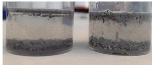
Figura 15. Separación para S:L = 50. Agua destilada y H2O2 respectivamente
